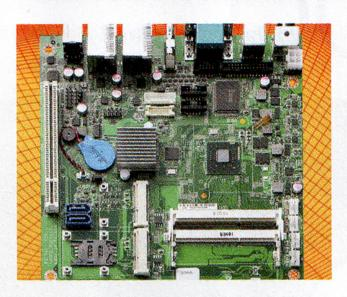
Mit dem NEX 604 steht ein Industriestandard-Mainboard mit Intels Atom D2550 Dual-Core-Prozessor (1,86 GHz) und integrierter Grafikkarte Power VR SGX 545 zur Verfügung. Es unterstützt
