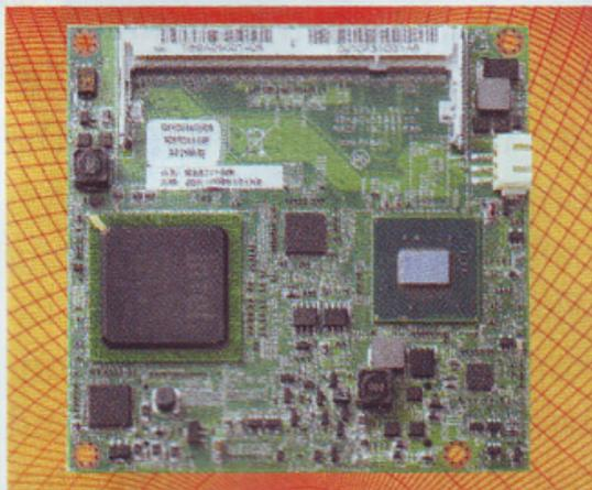
Das COM ICES 251X basiert auf der PICMG COM.0 Rev. 1.0 Spezifikation und ist auf Umgebungen mit kritischen Bedingungen ausgelegt. Es arbeitet bei Temperaturen zwischen  $-40$  und  $85$  °C
