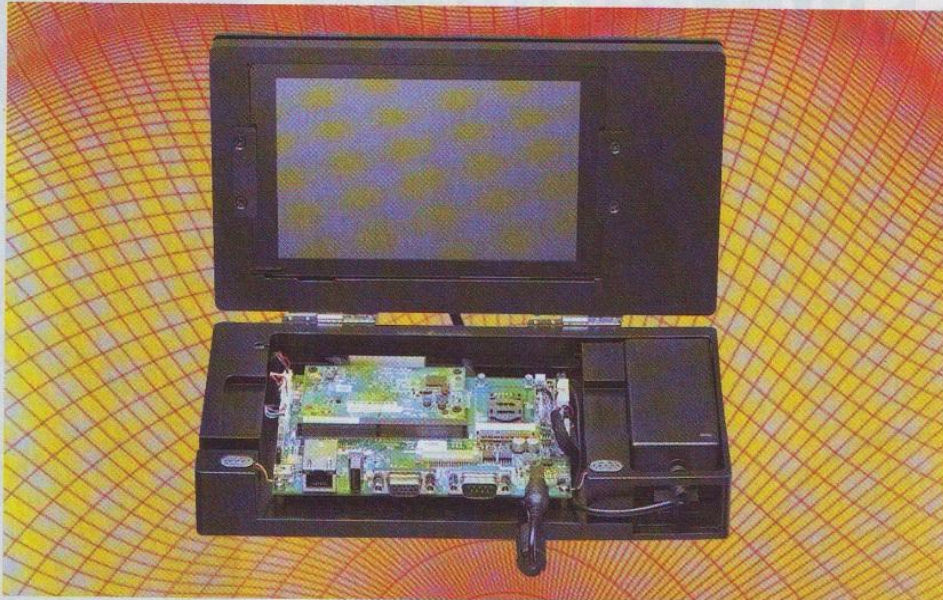
Das »ACEK 3354-7P« von IPC2U ist eine umfangreich ausgestattete Entwicklerumgebung auf Basis eines ULP-COM.
